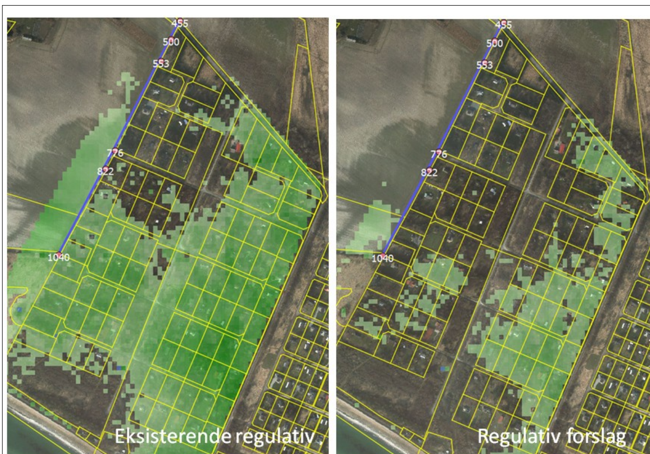
Figur 14: Dræningsforhold ved afstrømning svarende til vinter maksimum median (2 års hændelse) (59 l/s/km 2 ), med fri dræning til KVL60. Blå farver markerer områder, som slet ikke kan drænes. Grønne farver viser områder hvor der kan opnås drændybder mellem 0 og 1 m, medens områder uden farvemarkering er områder hvor der kan opnås drændybder over 1 meter. Området udenfor det vestlige Hummingen Strand er ikke med i analysen, så her skal der altså ikke lægges betydning i, at der ikke er farvemarkering.
